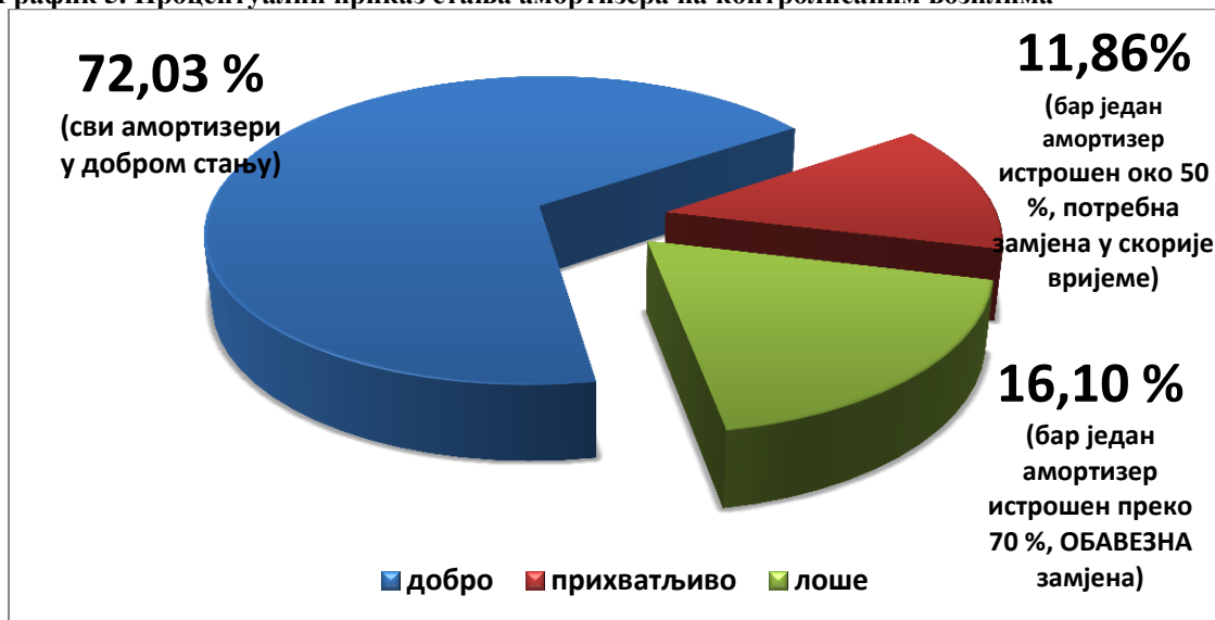
График 5. Процентуални приказ стања амортизера на контролисаним возилима
