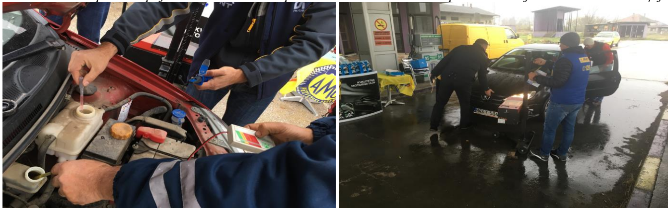
Слике 3. и 4. Преглед вриједности кочионе и расхладне течности и исправности свјетлосне сигнализације
