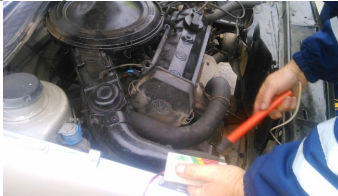
Слика 5. и слика 6. Уређај за испитивање амортизера и контрола плинске инсталације
