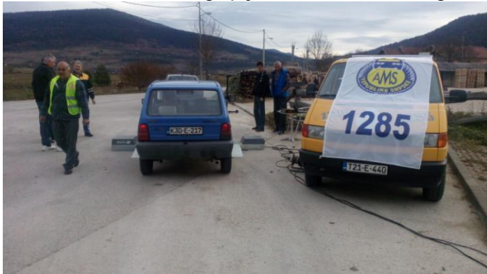
Слика 5. и слика 6. Уређај за испитивање амортизера и контрола плинске инсталације
