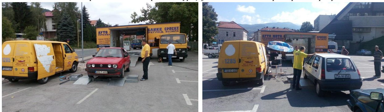
Слика 1. и слика 2. Покретни технички преглед и уређај за испитивање амортизера на терену
