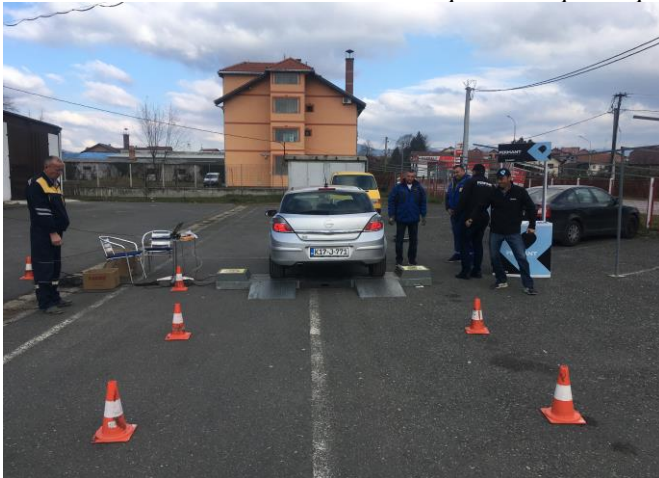
Слика 5. и слика 6. Контрола амортизера у Приједору и контрола плинске инсталације
