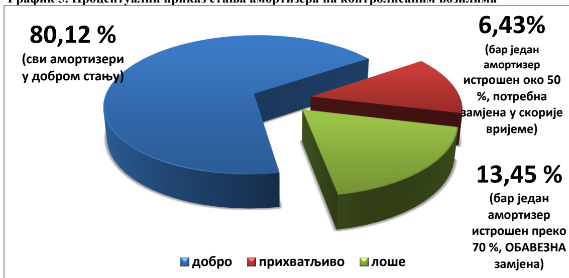
График 5. Процентуални приказ стања амортизера на контролисаним возилима
